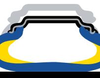
Tecnología desarrollada por Goodyear® que permite al vehículo mantenerse en movimiento cuando la llanta ha perdido presión de aire por una pinchadura.
